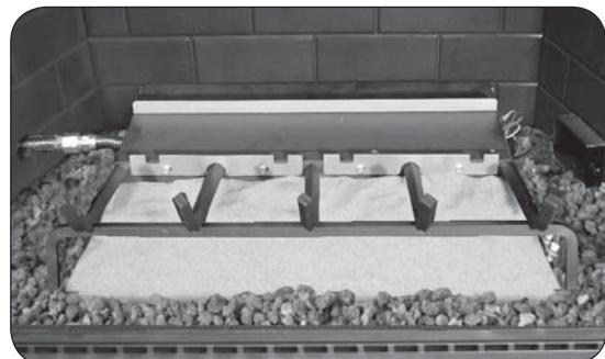
Fig. 15-2 Place sand/vermiculite granules
