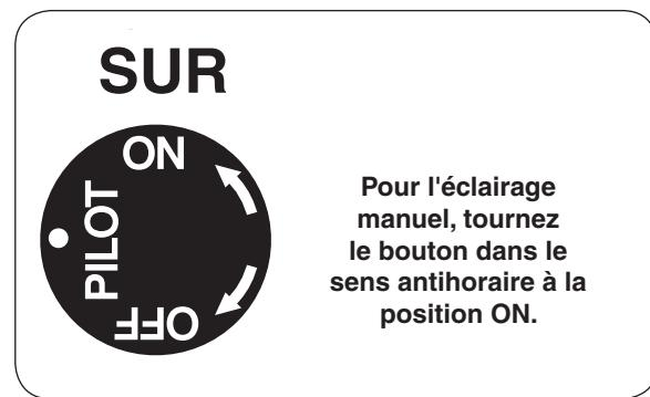
Fig. 24-1 Détail bouton de commande (SUR)
