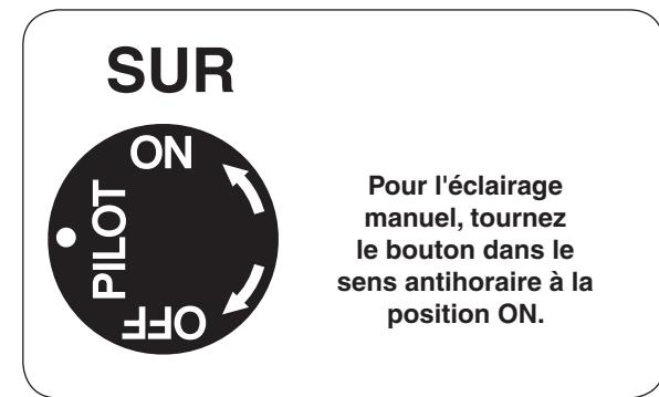
Fig. 28-3 Détail bouton de commande (SUR)
