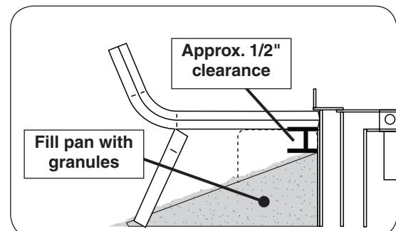
Fig. 15-3 Sand/vermiculite granules detail
