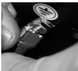
8. Connectez le raccord d'arrivée de gaz sur l'alimentation en gaz en conformité avec les normes pour installations au gaz et la section d'installation du gaz de ce manuel. Effectuez un test de fuite avec de l'eau savonneuse.
